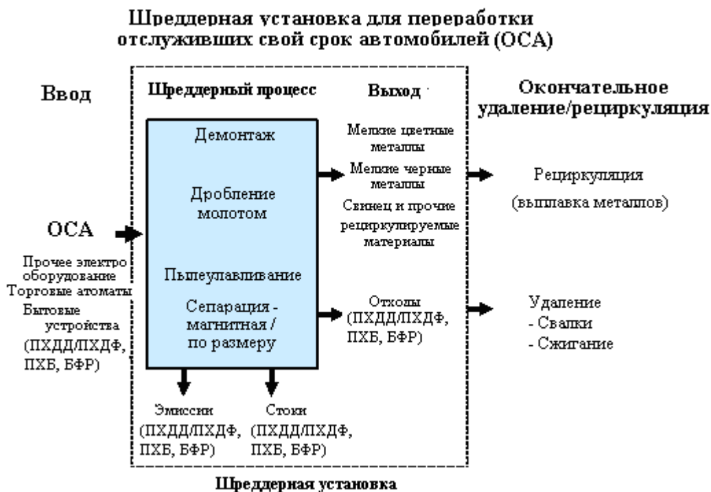
Рис. 1. Общая схема процесса переработки отслуживших свой срок автомобилей
