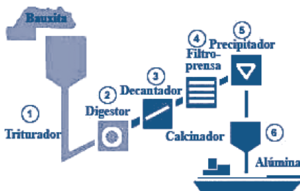
■ Figura 2. Esquema simplificado de la producción de alúmina
